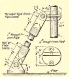
Fig. 211 .- Wall or floor brace.
